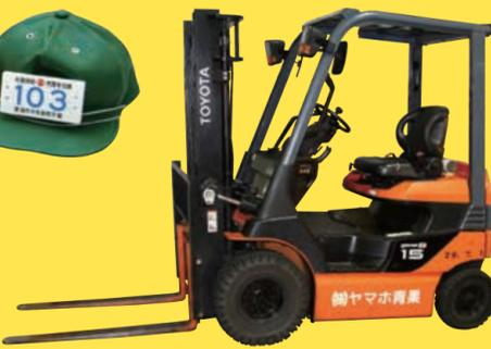
**フォークリフト** 車体前方にフォーク(つめ)が備えられた荷役運搬車。トラックに荷物を積み下ろしする時や大量の荷物を移動する時に使われます。
