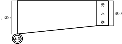
取付管土工（市道B断面 取付管 150mm 転用土）
