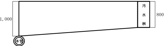
取付管土工（市道C断面 取付管 150mm 転用土）
