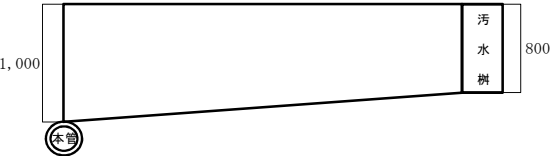
取付管土工（市道C断面 取付管 150mm 転用土）
