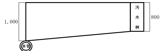
取付管土工（市道C断面 取付管 150mm 転用土）
