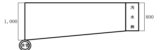
取付管土工（市道C断面 取付管 150mm 転用土）
