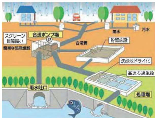
合流式下水道の改善イメージ
