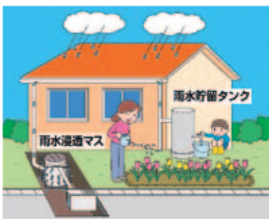
宅地内の雨水貯留浸透施設
