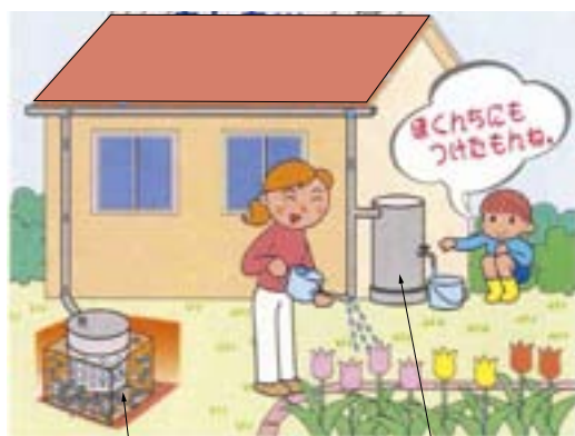
宅地内の雨水貯留浸透施設
