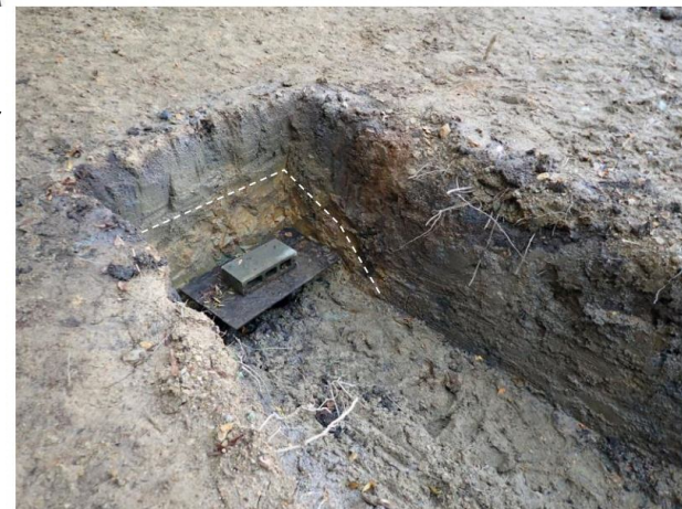
写真6 坑口の周囲 破線が土壌と地山の境界
