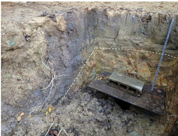
写真5 坑口の周囲 破線が土壌と地山の境界
