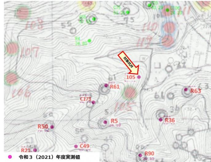
令和3年度新潟市秋葉区小口地区石油坑井封鎖に係る石油坑井調査業務委託現況位置図と、昭和55年度調査による手掘り坑井位置図を重ね合わせ、加筆 ※令和3年度調査では対象坑井を105号井として取扱い
