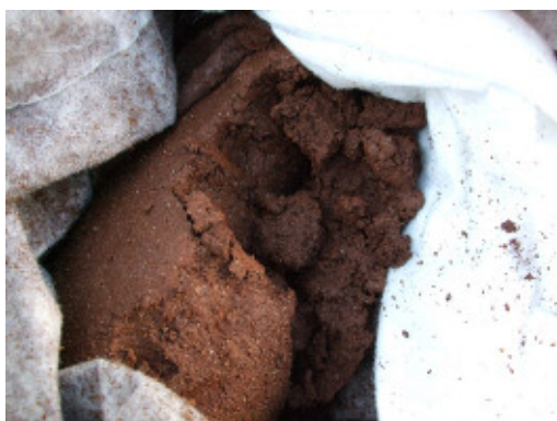
配水池から吸い上げられた沈殿物
