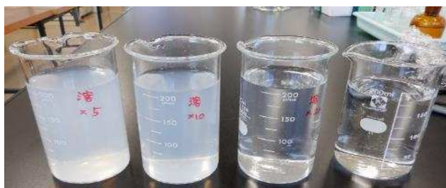
図3 希釈した試料の様子(pH調整後) (左から、5倍希釈、10倍希釈、20倍希釈、純水)
