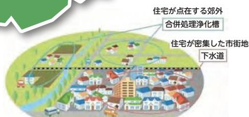
汚水処理施設整備の概念図
