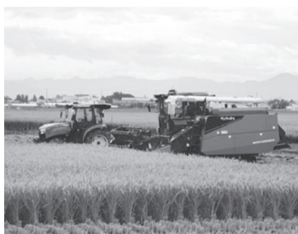
自動運転コンバインおよび自動運転トラクタの連携による稲刈り同時耕運の様子
