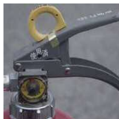
× 表示装置の脱落
