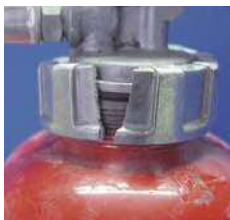
× キャップの破損
