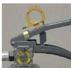
× 安全栓の抜けかけ
