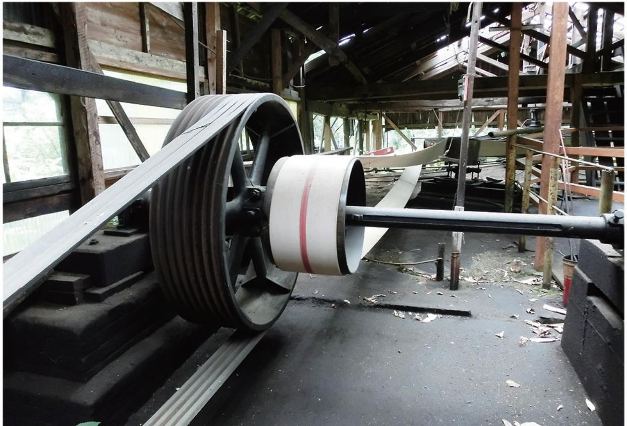
大正8（1919）年設置（推定）の米国ナショナルサプライ社製平ベルト2段式ポンピングパワー1号機
